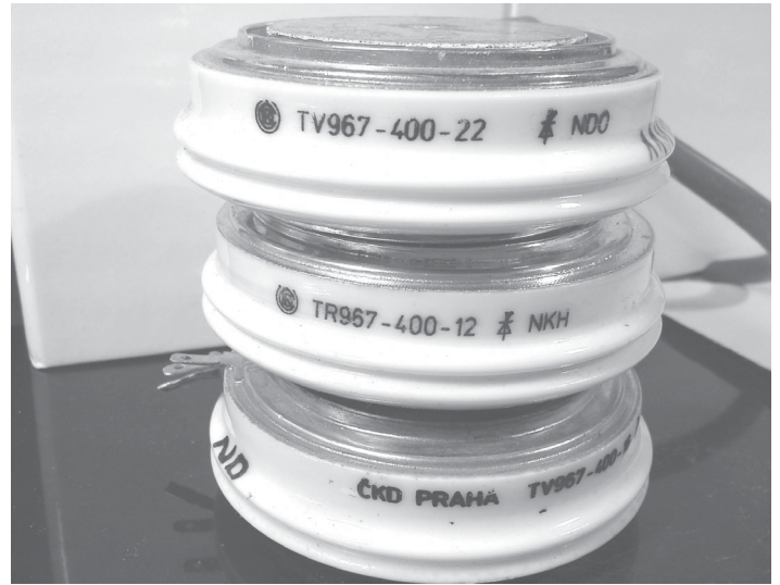
Рис. 1 Внешний вид тиристоров «СКД Прага» и «Polovodice».
