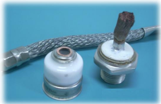
Рис. 4 Элементы паяной конструкции лавинного диода с гибким силовым выводом (фальсификат ДЛ161).
