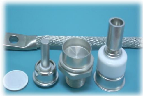
Рис. 3 Элементы прижимной конструкции лавинного диода с гибким силовым выводом.
