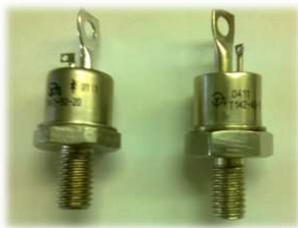
РИС. 7 - Слева – подлинный тиристор типа Т142 производства ООО «Элемент-Преобразователь». Справа – фальсифицированный.
