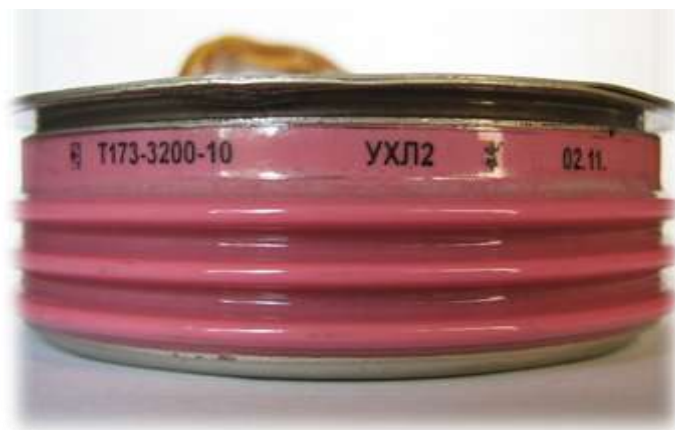
РИС. 3 - Фальсифицированная маркировка тиристора Т173 производства ОАО «Электровыпрямитель», выполненная прозрачной липкой лентой (дата на маркировке 02.11, а фактически тиристор произведен не позднее 2000 г.).
