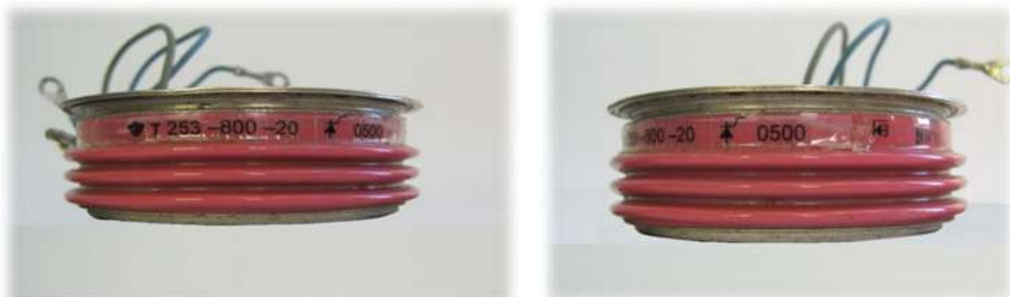
РИС. 4 - Тиристор типа Т253 с фальсифицированной маркировкой. Слева – товарный знак ЗАО «Протон-Электротекс», справа – ОАО «Электровыпрямитель».
