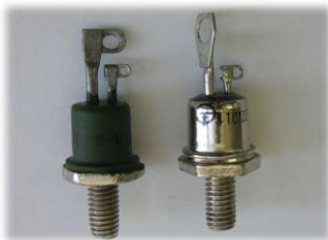
РИС. 9 - Слева – симистор (триак) типа ТС2. Справа – триак типа ТС122 производства ООО «Элемент-Преобразователь».
