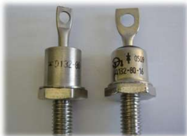
РИС. 8 - Слева – фальсифицированный диод типа Д132. Справа – диод типа Д132 производства ООО «Элемент-Преобразователь».
