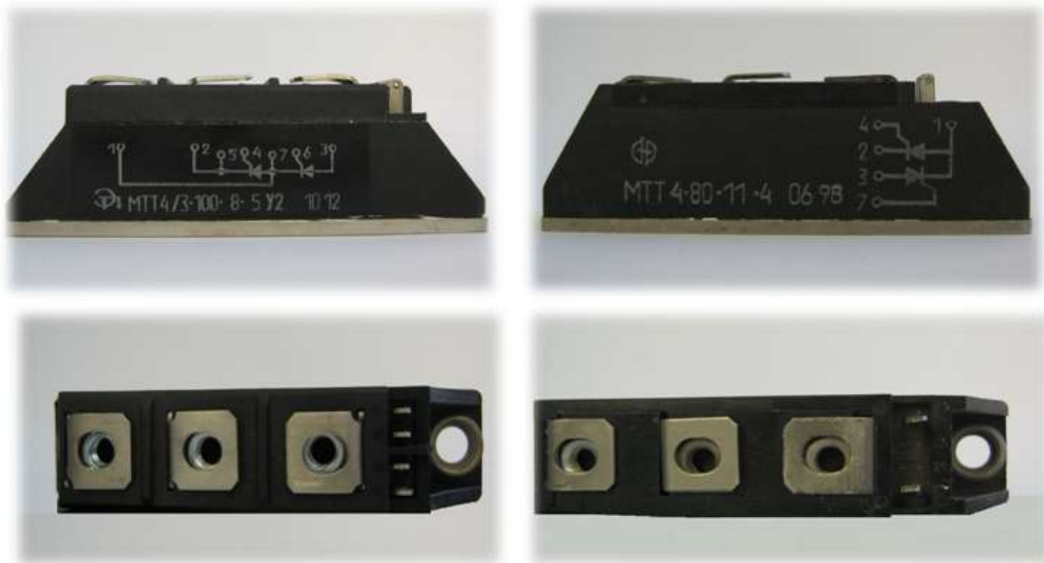
РИС. 6 - Слева – модуль типа МТТ4/3 производства ООО «Элемент-Преобразователь». Справа – старый модуль типа МТТ2 с фальсифицированной маркировкой.
