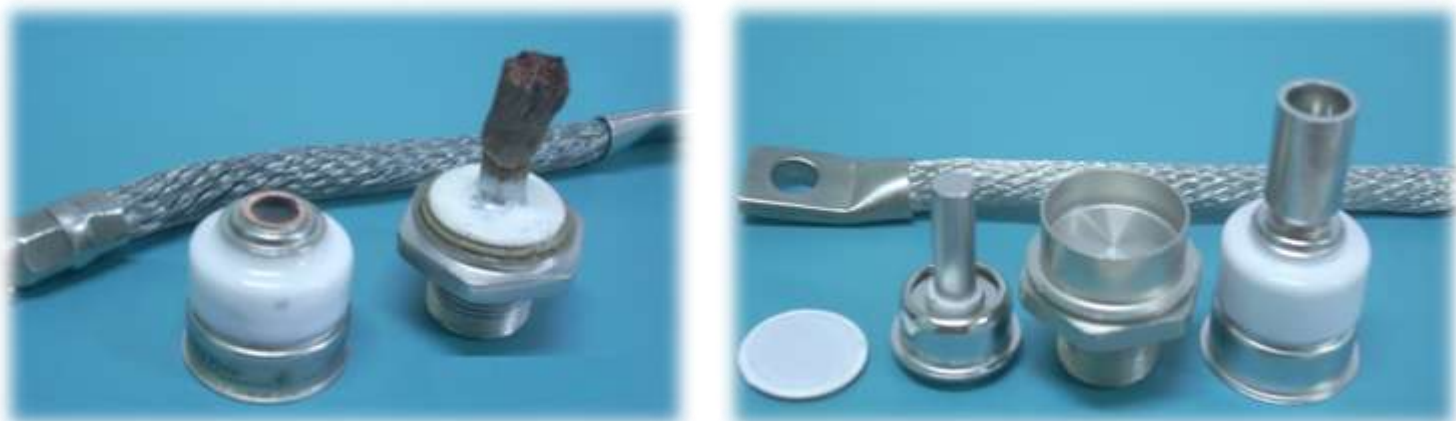
РИС. 1 - Элементы конструкции паяного и прижимного диодов типа ДЛ161.
