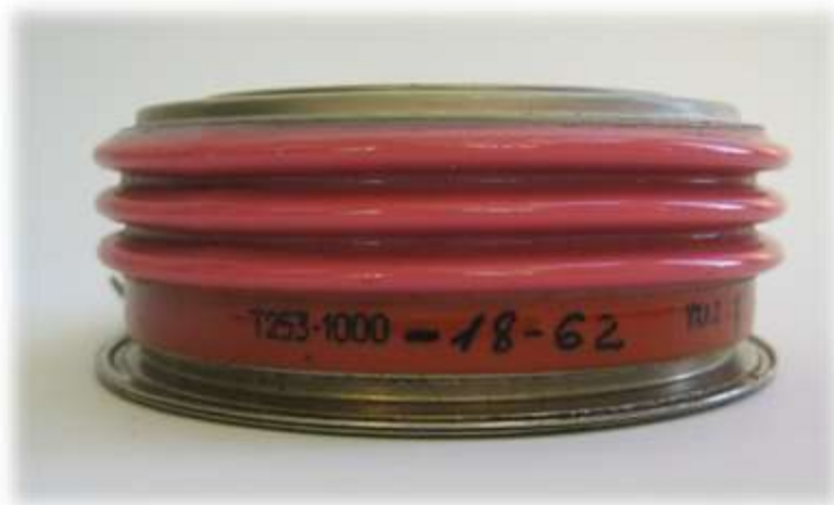
РИС. 5 - Тиристор типа Т253 с «перевернутой» маркировкой.
