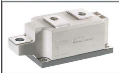
Рис. 2. Фальшивые модули SKKD 380 и фрагмент спецификации
